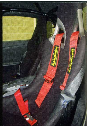
Wohnkomfort wie im GT3 RS: Profilschalensitz, rote Schroth-Sechspunktgurte, Alcantara-Dachhimmel, erweiterter Schraubkäfig
