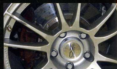
Im Wettbewerb thermisch hochbelastet: Bitte beachten Sie die Verfärbung des hinteren, einst gelben PCCB-Bremssattels!
